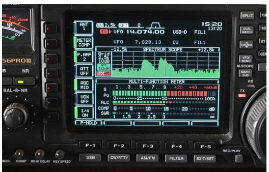
Hier links ist der Einstellregler von Line-OUT zu sehr aufgedreht. ALC ist leicht rot.
