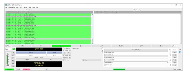
Links unten ist die kleine senkrechte Balkenanzeige des NF-Eingangs-Pegels. Er wird jetzt nicht rot, also nicht übersteuert / also OK.
