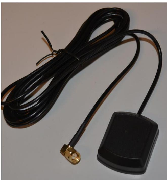
Diese PKW-Auto-GPS-Antenne ist eine Aktive Antenne.
