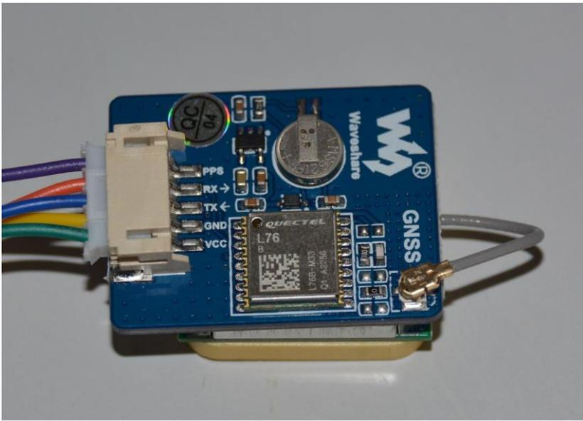
Links erkennt man die Anschlüsse PPS, Rxd, Txd und die Speisespannung Vcc für 3,3Volt oder 5,0Volt. GND - Masse
